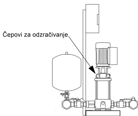
Slika 17 Položaj čepova za odzračivanje u sistemima s CR(I)E crpkama
