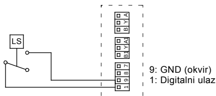
Slika 14 Nivo sklopka spojena na crpku 1
