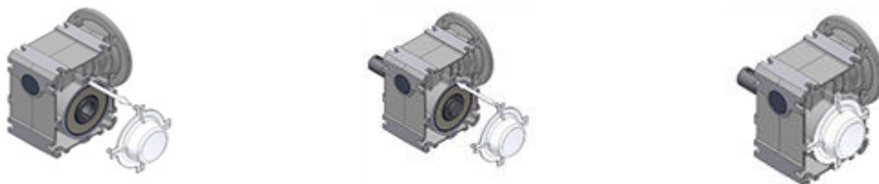
Slika 14: Demontaža i montaža pokrovne kape
