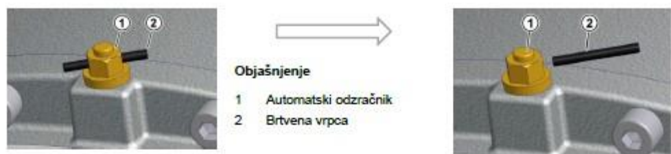
Slika 21: Aktiviranje automatskog odzračnika
