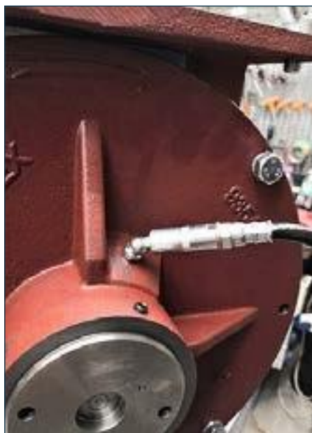
PODMAZIVANJE BRTVI RVS/C 80 NA SLOBODNOJ STRANI
