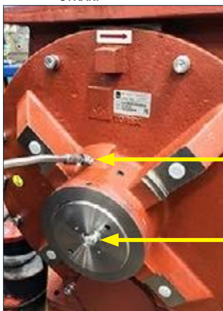
PODMAZIVANJE BRTVI RVS/C 80 NA SLOBODNOJ STRANI
