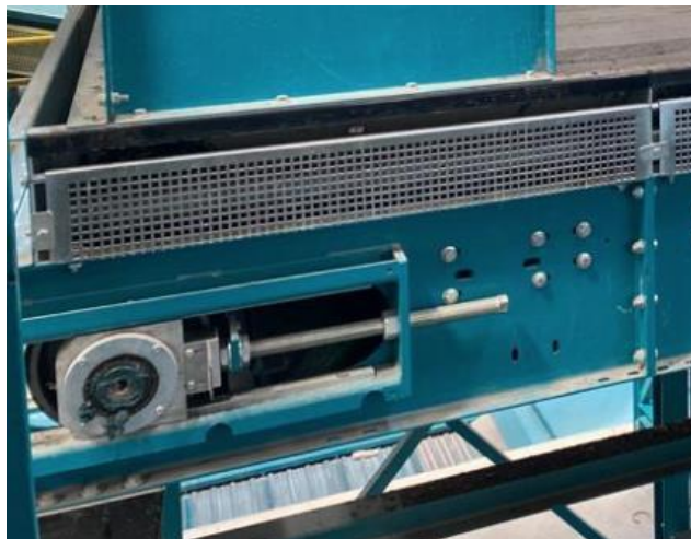
Slika 3.1.1 Sustav za zatezanje trake optičkog transportera
